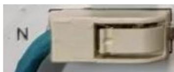
La source lumineuse peut être remplacée par ce connecteur entre le driver et la source lumineuse
